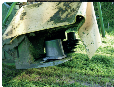
La faucheuse rotative est l'un des outils privilégiés pour la précoupe. Elle est efficace et permet un débit de chantier élevé.
