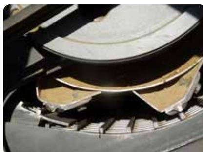
En luzerne : le contre-batteur ne sera pas aveuglé. Ne pas utiliser de plaque d'ébarbage (battage trop agressif, diminution de la faculté germinative et baisse du débit de la machine), ni de barres ou battes d'ébarbage placées sous le contre-batteur.
