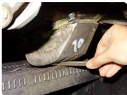
Le point « zéro » doit être réalisé avec des jauges d'épaisseur afin de valider les futurs réglages de contre-rotor ou contre-batteur.
