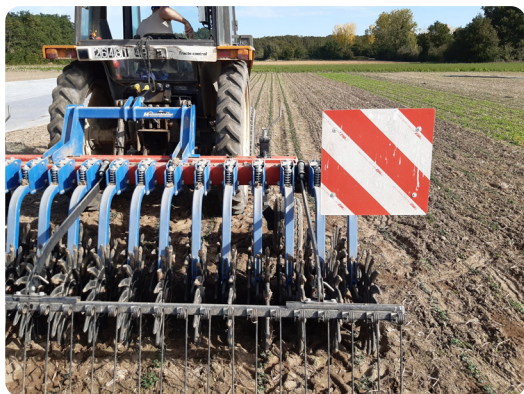
Plusieurs outils mécaniques ont été testés, ici, la houe rotative.
