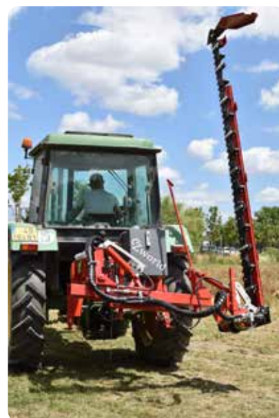
Faucheuse latérale à double lamier plat
